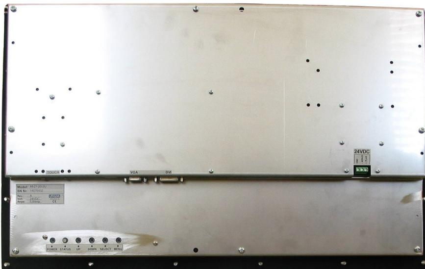
**Rückseite Monitor mit Standardfrontplatte und Montagebolzen**
